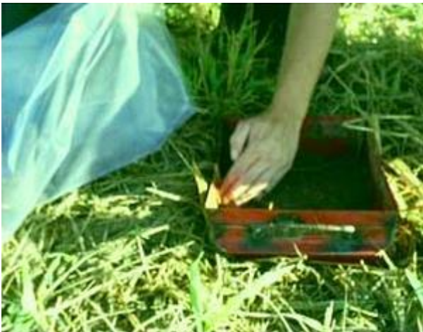
Figura 2. Coleta de serapilheira e gabarito metálico utilizado para a amostragem da macrofauna do solo - método dos monolitos.
