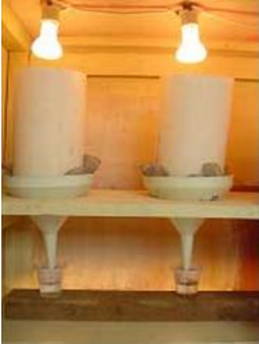
Figura 1. Extrator de Berlesse: no interior do cilindro, amostra de solo submetida à radiação luminosa. Acima do funil, tela de 2,0mm e a baixo, pote com formou para captura da mesofauna.
