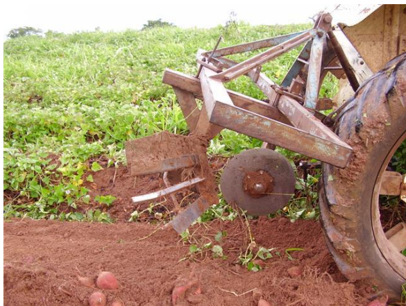
Figura 2. Implemento agrícola adaptado para etapa de colheita de batata-doce.
